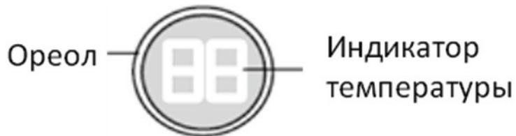
Режим индикатора. В зависимости от выбора различных функций ореол светится различными цветами.
